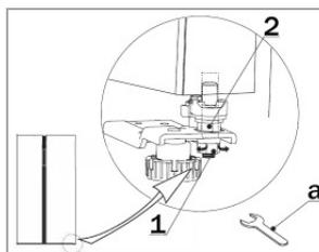
Sind die Gerätetüren ungleich hoch und schließen nicht parallel zueinander ab, muss die Kühlraumtür ausgerichtet werden. **Maximaler Toleranzausgleich beträgt 5 mm!**
